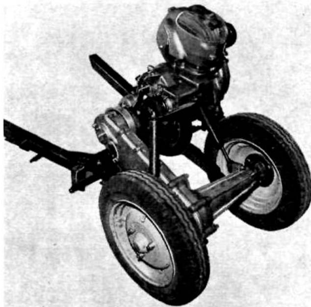
Le moteur de la VELAM Isetta est du type « monocylindre en U » c'est-à-dire qu'on peut imaginer qu'il s'agit d'un cylindre rectiligne semblable à celui de la fig. 1 avec pistons opposés, qu'on aurait plié en deux pour amener les pistons côte à côte comme sur le croquis de la fig. 2.
